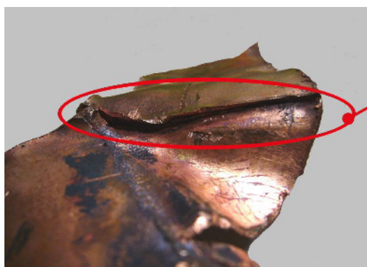
Soldadura de dois tubos de cobre por brasagem, vista por dentro após corte longitudinal dos tubos e respectiva abertura
