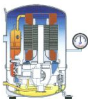
O sistema está no ciclo de paragem, no entanto, durante este período, o refrigerante migrou para o compressor e misturou-se com o óleo. Observe a pressão.
