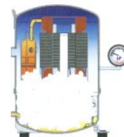
O cárter fica cheio de espuma do refrigerante e gotas de óleo, que serão agora drenadas para as condutas de óleo do compressor.
