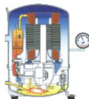
Quando o sistema necessita de arrefecimento e o compressor arranca, a pressão desce rapidamente, observe o manómetro, e o refrigerante 'explode', separando-se do óleo.
