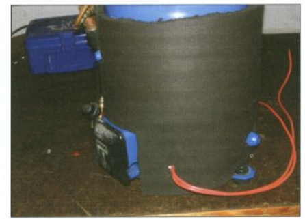
Este compressor está isolado e equipado com uma resistência de carter para evitar a migração do refrigerante para o óleo do compressor.
