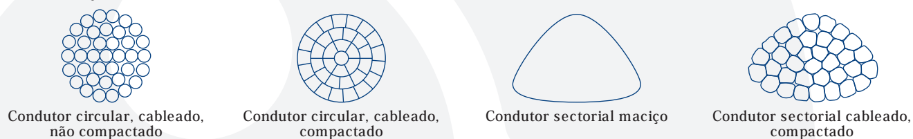
FIG. 1.1 - SECÇÃO RECTA TRANSVERSAL DE VÁRIOS TIPOS DE CONDUTORES
