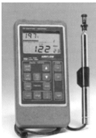
Fig. 7. Termo-anemómetro de leitura digital
