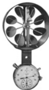
Fig. 5. Anemómetro mecânico com cronómetro
