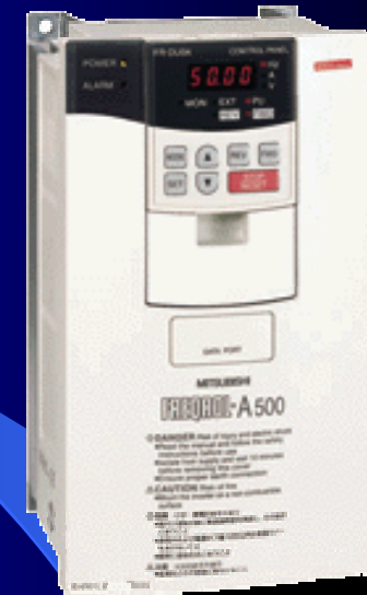
Inversor 55 kW 0 – 400 Hz para motor assíncrono com controlo vectorial
