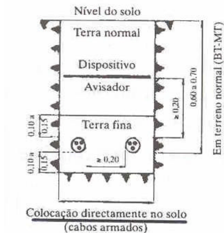
Fig.: Canalização Colocada Directamente no Solo.
