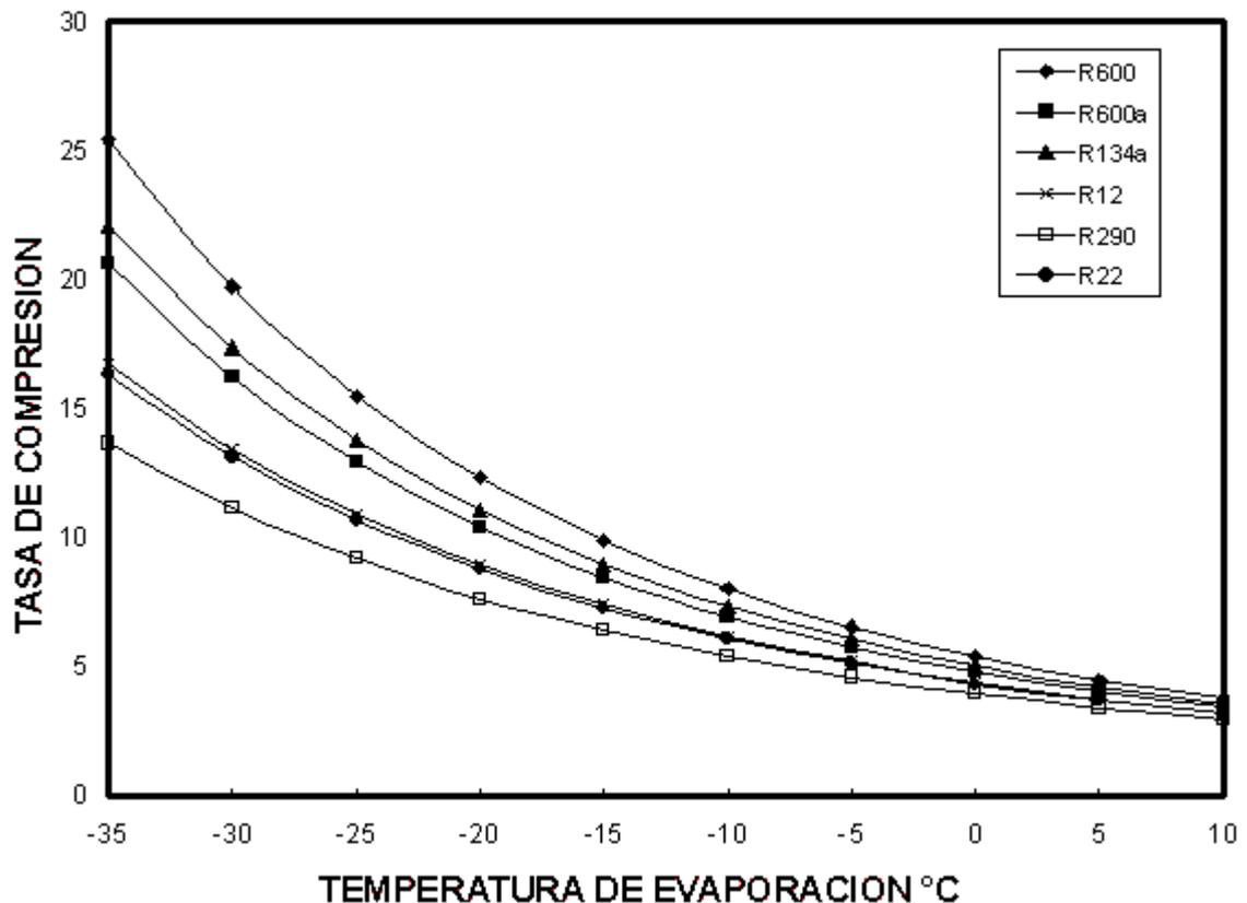
El calor Latente de evaporación de los hidrocarburos es mayor comparado al del R12. Por lo tanto, una determinada capacidad frigorífica puede ser obtenida con un menor flujo de masa. Entretanto, para la determinación del desplazamiento volumétrico del compresor, se debe considerar que la densidad ( $\text{Kg}/\text{m}^3$ ) de los hidrocarburos en la línea del retorno es menor.
