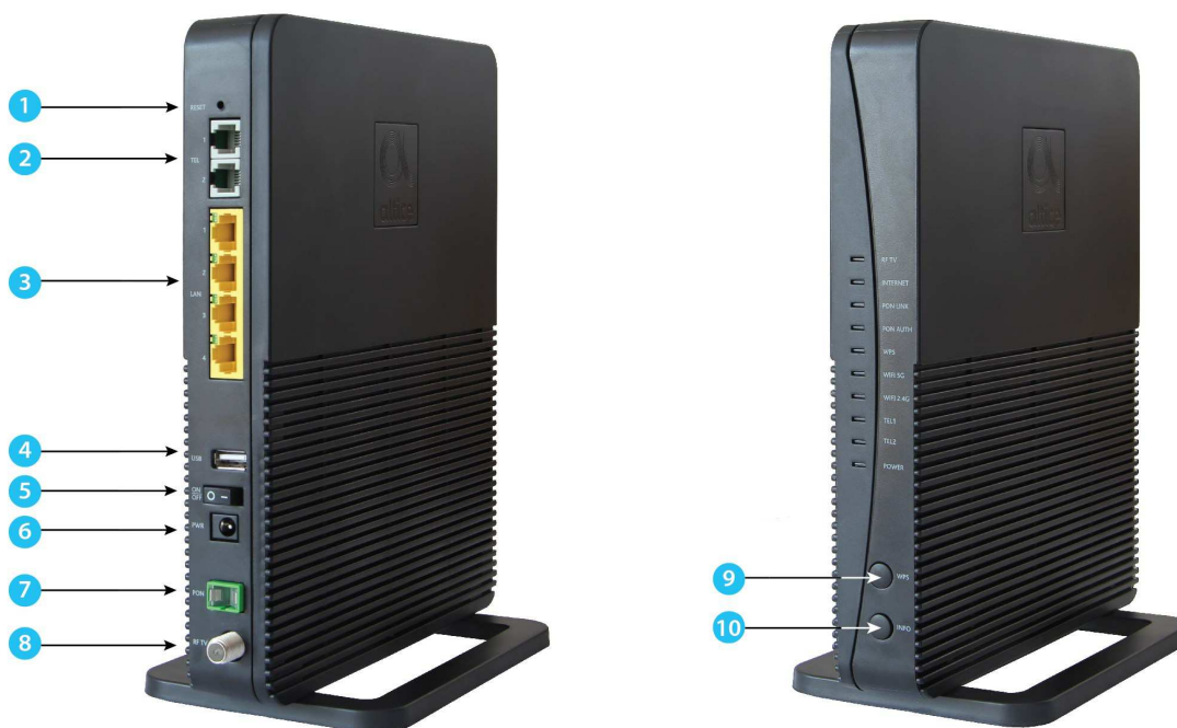
Figura 1: Visão geral dos conectores da FiberGateway
