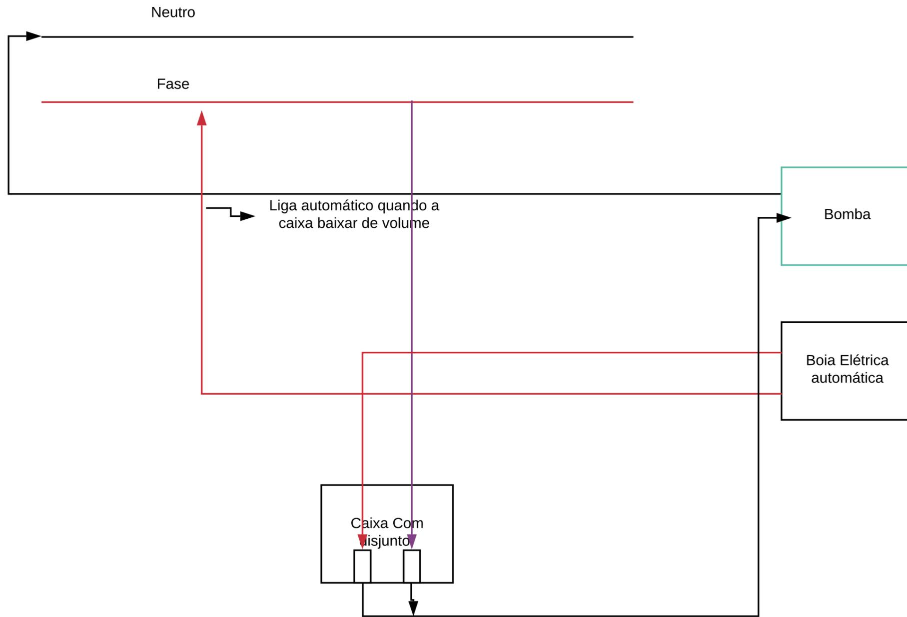
Quando desligar o disjuntor da esquerda (boia automática) e ligar o da direita a bomba terá que funcionar constantemente. A boia automática será desligada.
