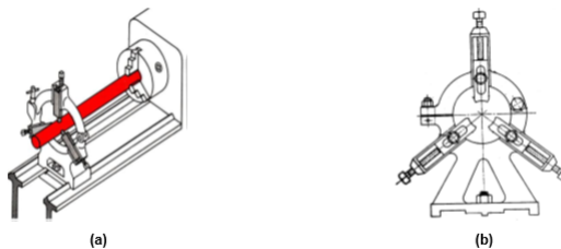
Figura 7.26 – (a) Representação da montagem com luneta fixa, (b) Vista lateral da luneta fixa (Freire, 1979)
