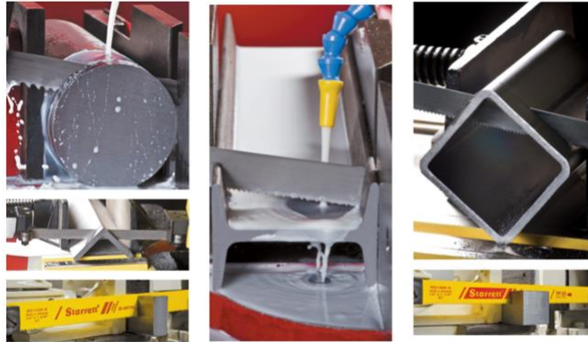
Figura 2.13 – Exemplos de como fixar peças para a serragem (Starrett, 2014)
