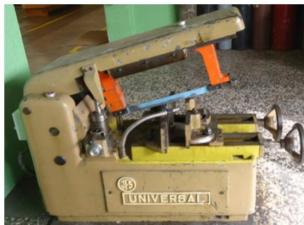
Figura 2.3 - Serrote alternativo (Laboratório Tecnologia Oficial – DEM/ISEC)
