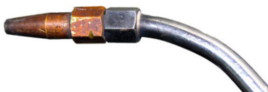
Fig. 36 – Ponteira de maçarico para brasagem oxi-acetilénica (APIEF)
