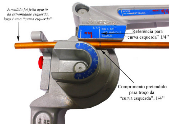
Fig. 12 – Marcação do ponto para curva esquerda, tubo de 1/4” (APIEF)
