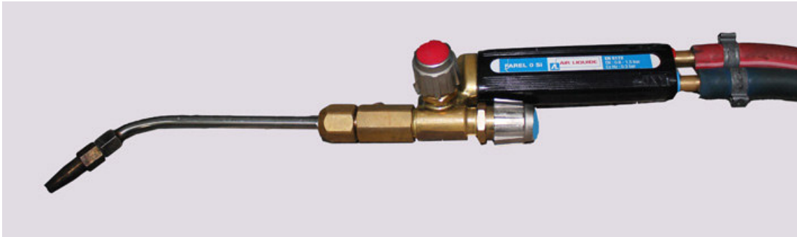
Fig. 34 – Maçarico para brasagem oxi-acetilénica (APIEF)
