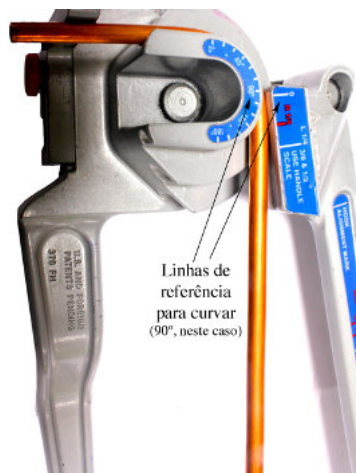
Fig. 13 – Curva esquerda a 90°, tubo de 1/4” (APIEF)
