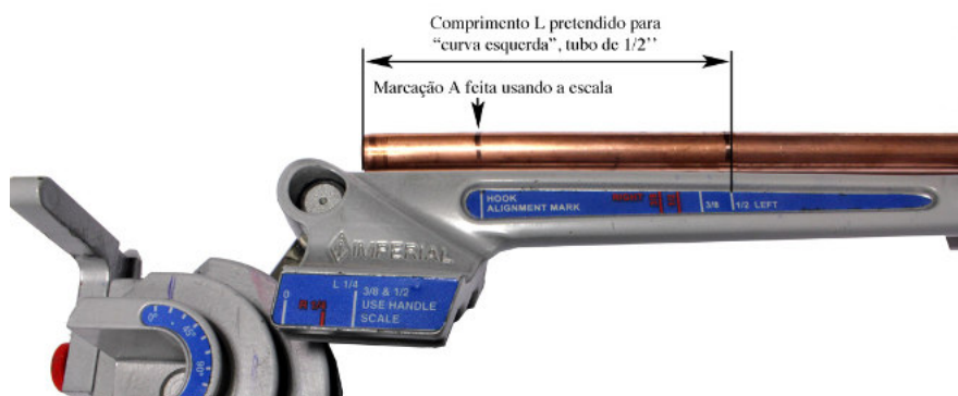
Fig. 16 – Marcação do ponto para curva esquerda, tubo de 3/8” – utilização da escala de compensação (APIEF)
