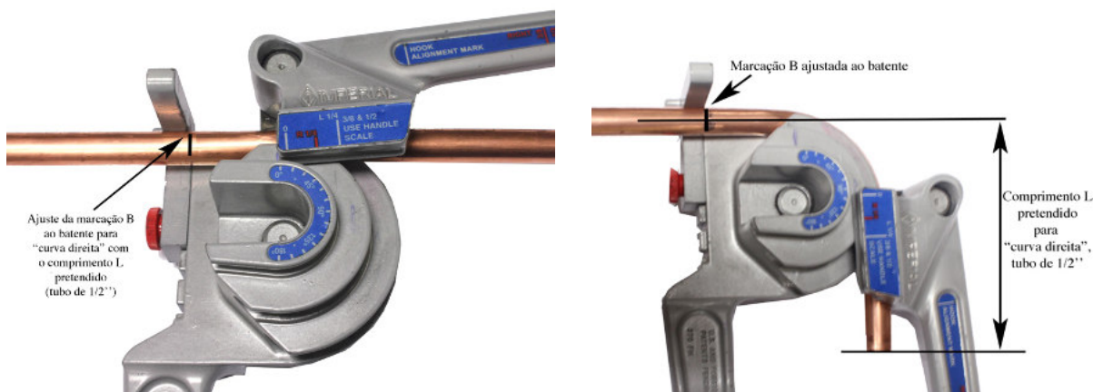
Fig. 19 – Colocação e curva direita, 90°, tubo de 3/8” (APIEF)
