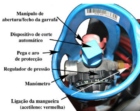
Fig. 32 – Comando e segurança numa garrafa de acetileno (APIEF)
