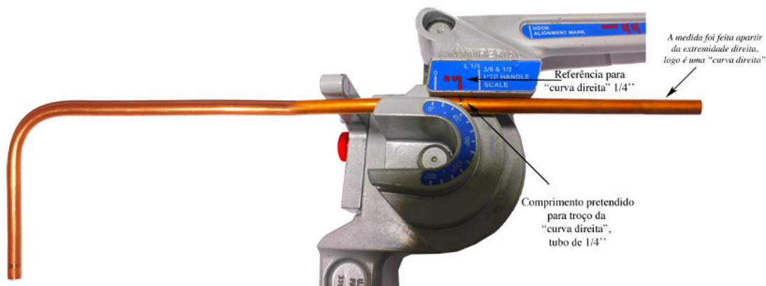
Fig. 14 – Marcação do ponto para curva direita, tubo de 1/4" (APIEF)
