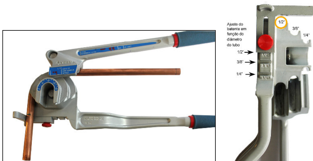
Fig. 10 - Aparelho de curvar-tubos (também chamado “máquina de virar tubos”) e vista frontal do mecanismo de ajuste do batente, ajustado para tubo de meia polegada (APIEF)
