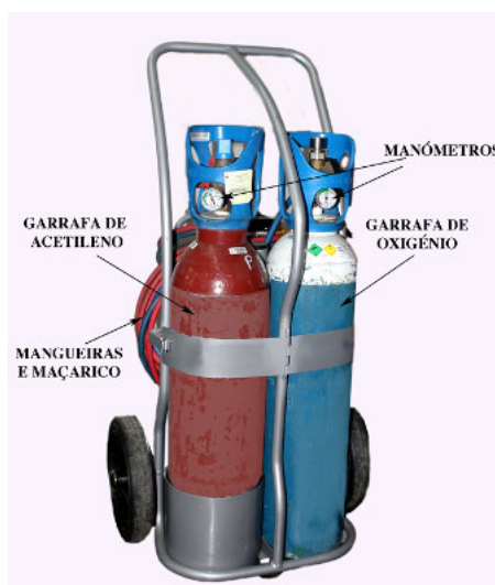
Fig. 30 – Conjunto de equipamento para brasagem (APIEF)
