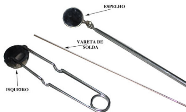
Fig. 37 – Acessórios para brasagem oxi-acetilénica – espelho, isqueiro e vareta de “solda” (material de enchimento) (APIEF)
