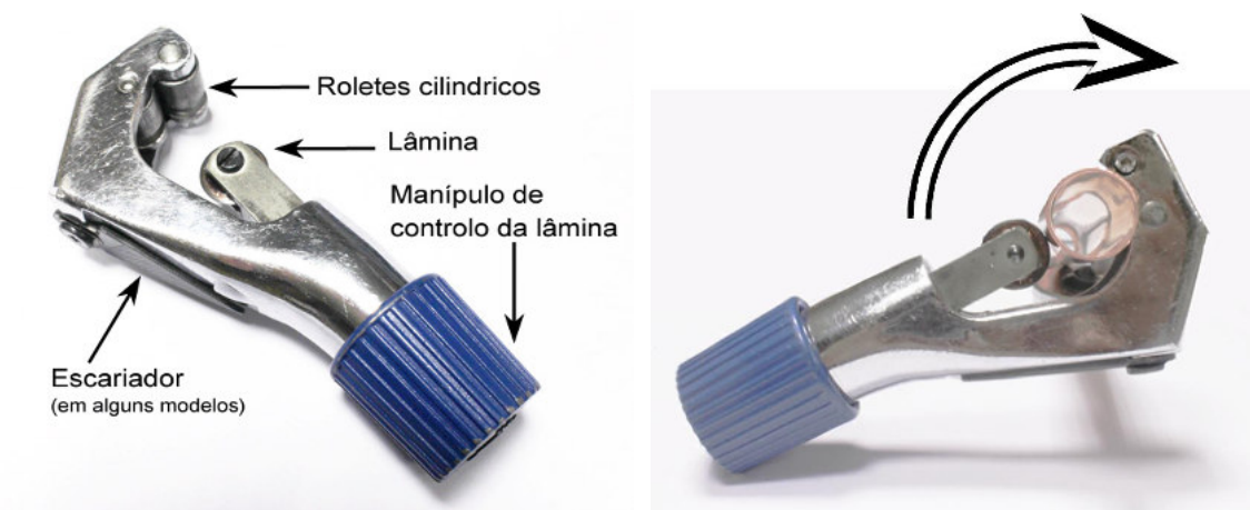
Fig. 1 – Ferramenta corta-tubos. Para efectuar o corte, e tendo com referencia a figura do lado direito, a ferramenta deve rodar em torno do tubo no sentido dos ponteiros de um relógio (APIEF)
