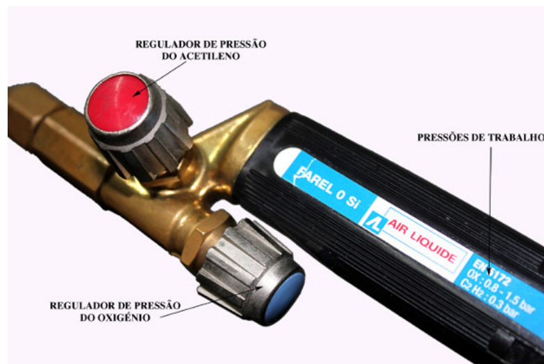
Fig. 35 – Maçarico para brasagem oxi-acetilénica – detalhe (APIEF)
