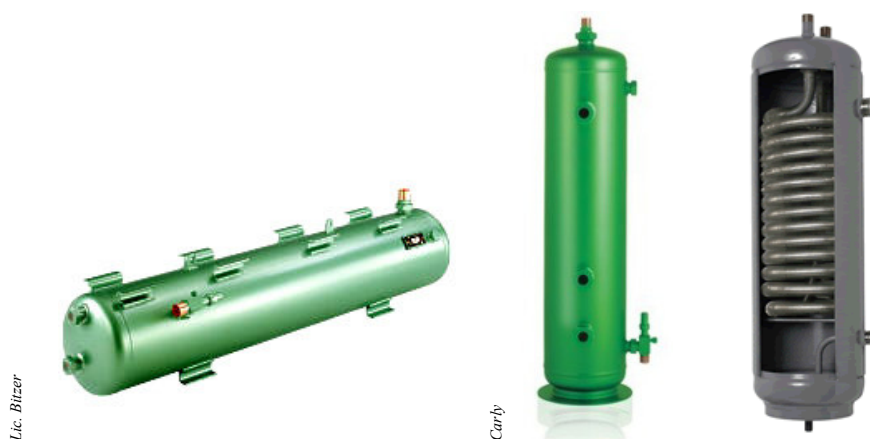
Fig. 39 – Depósitos de líquido horizontal e vertical e condensador com depósito de líquido integrado, visto em corte
