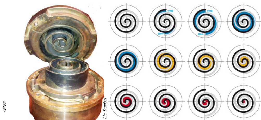
Fig. 9 – Partes móvel e fixa de um compressor “scroll” e respectivo funcionamento. O fluido é admitido a baixa pressão (a azul) e, à medida que é conduzido para o centro a pressão vai aumentando (a vermelho)
