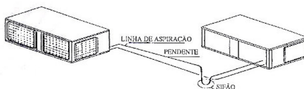
Figura 23: Unidade evaporadora e condensadora ao mesmo nível.
