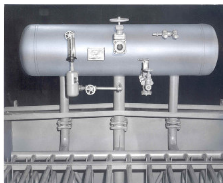
Fig. 44 - Evaporador inundado do tipo de imersão. À direita o reservatório de alimentação dos tubulares com líquido e de garantia de aspiração seca pelo compressor
