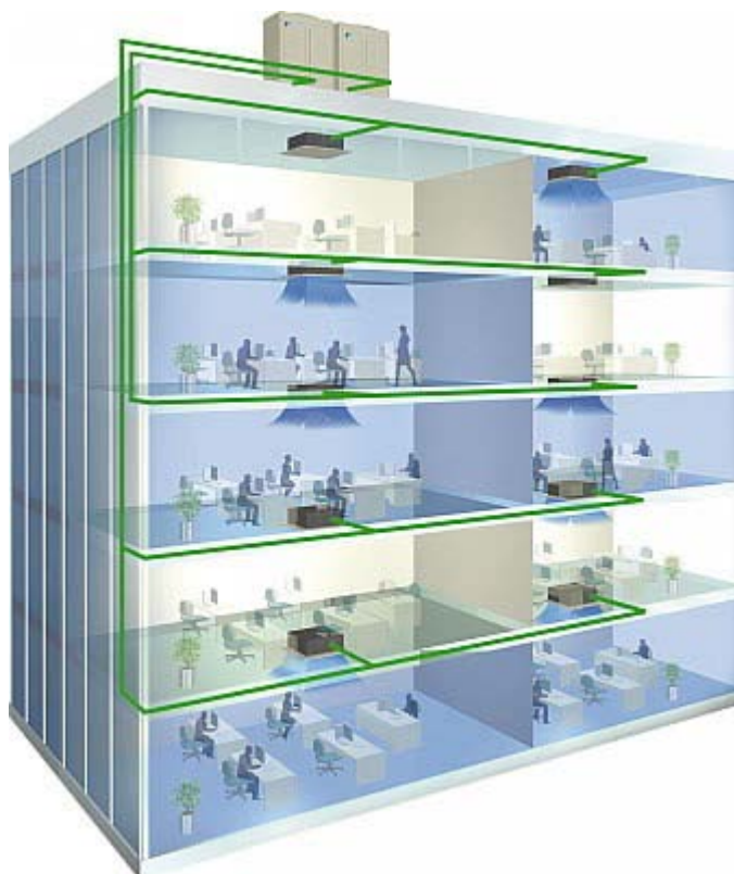
Figura 2.8. Esquema do sistema VRV aplicado num edifício (Daikin Air Conditioning, 2011).
