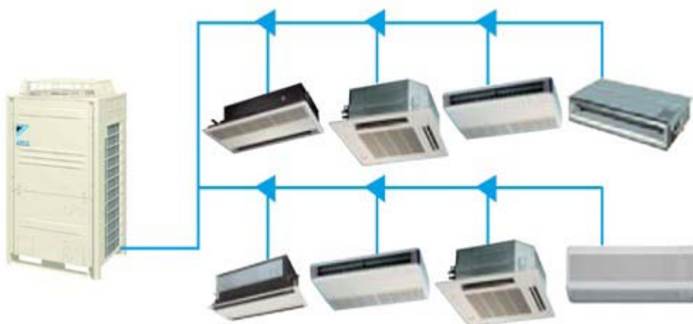
Figura 2.7. Esquema de ligação do sistema VRV (Klimasatis, 2011).
