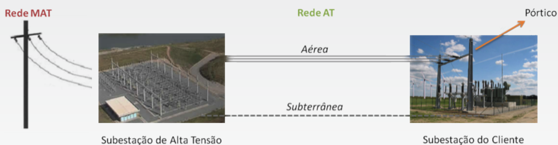
Figura 7.5 – Ligação em antena de uma instalação em Alta Tensão sem posto de corte
