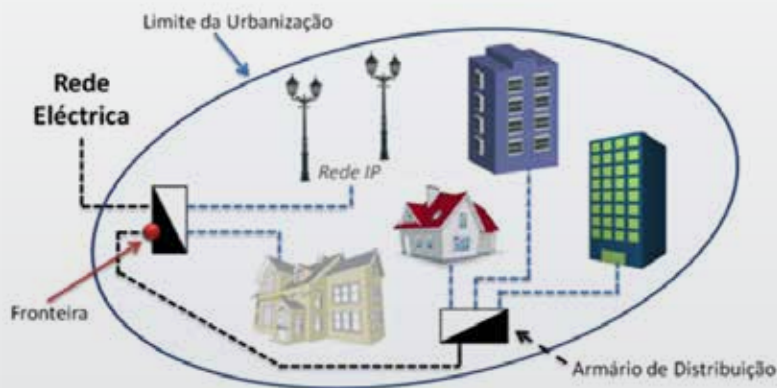
Figura 8.4 – Ligação à Rede Eléctrica de uma Urbanização, através de linha subterrânea
