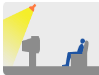
Figura 3. 6- Iluminação correcta sem ofuscamento
