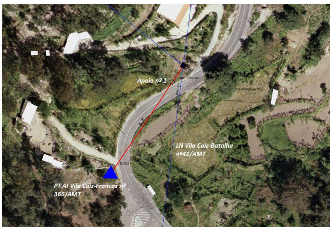
Figura 4.8 - Perspectiva da rede MT após intervenção (Fonte:SIT-DM)
