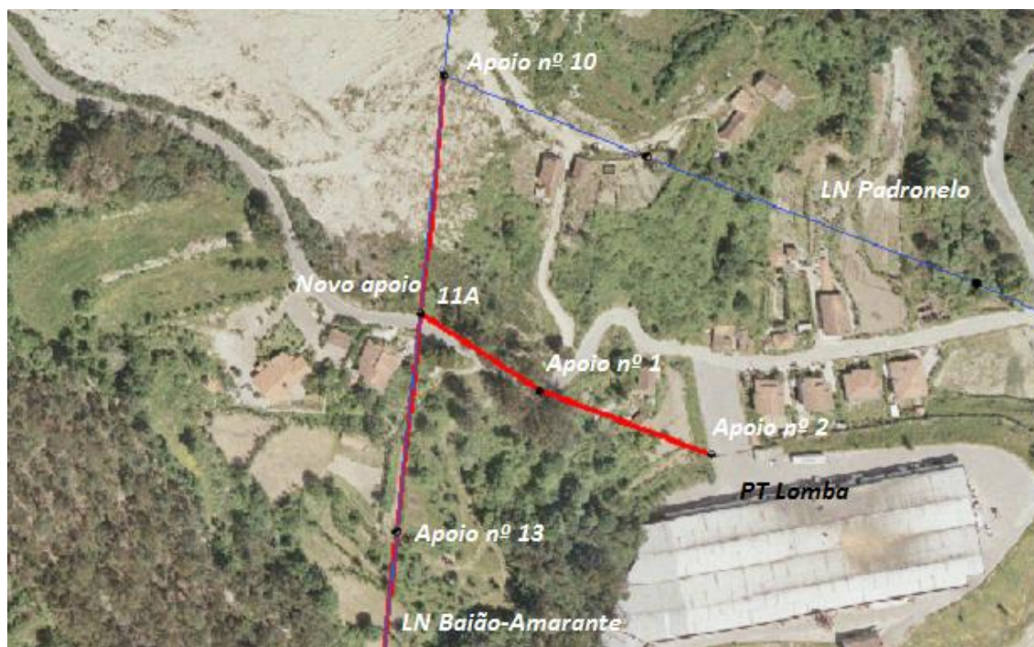
Figura 4.5 - Perspectiva da rede MT após intervenção (Fonte:SIT-DM)
