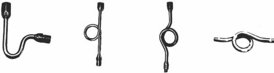
A - Cachimbo B - Rabo de Porco C - Bobina D - Alta Pressão Fig. 22 - Tipos de Sifão
