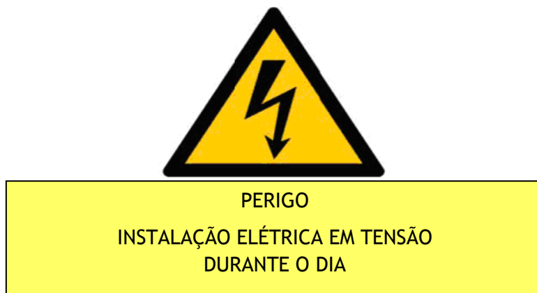
FIG. 25 – AVISO MODELO DA EXISTÊNCIA DE TENSÃO DO LADO DC (SISTEMA FOTOVOLTAICO)
