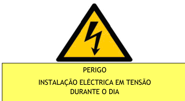
FIG. 42 – AVISO MODELO DA EXISTÊNCIA DE TENSÃO DO LADO DC (SISTEMA FOTOVOLTAICO)
