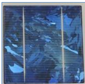
FIG. 13 – CÉLULA POLICRISTALINA
