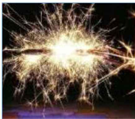
FIG. 39 – ARCO ELÉTRICO POR CURTO-CIRCUITO (12V, 20A)
