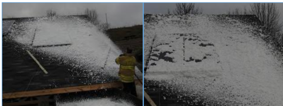
FIG. 48 - PAINEL FV ENSAIADO COBERTO DE ESPUMA
