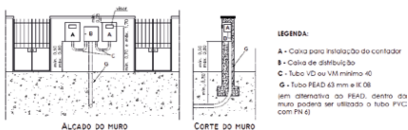
Figura 5.10 – Ligação a partir de rede subterrânea de moradias geminadas, em banda ou bifamiliares dotadas de muro
