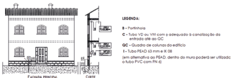
Figura 5.12 – Ligação a partir de rede subterrânea de edifícios colectivos sem muro
