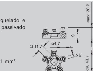
**MF** Duroplástico/resina melamina 150 (MF), cinza claro Ral 7035
