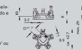
**MF** Duroplástico/resina melamina 150 (MF), cinza claro Ral 7035
