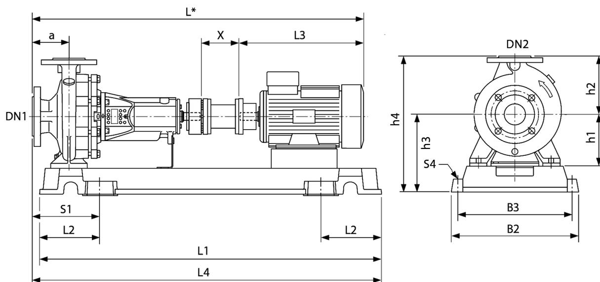
Acoplamento com espaçador
