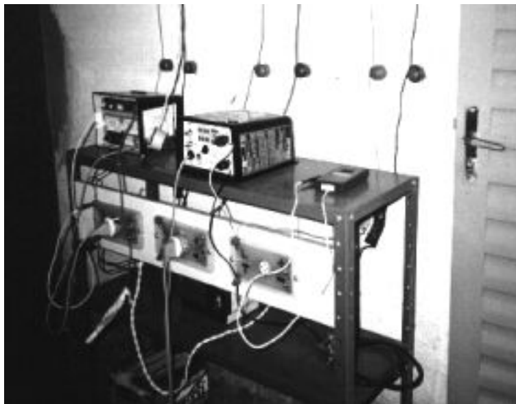
Figure 3.1: Sistema de controle dos eletrificadores de cerca
