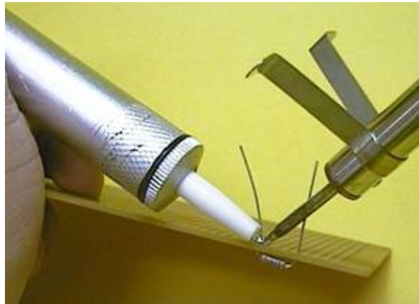
Figure 1.4: Dessoldando componentes.
