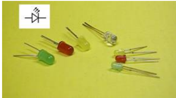
Figure 4.2: LEDs e seu símbolo.
