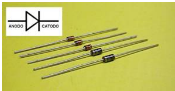
Figure 4.1: Diodos e seu símbolo.
