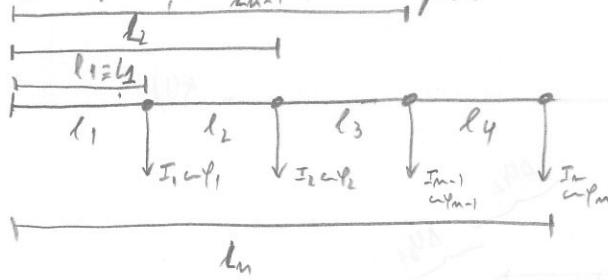
$$\Delta U_{\text{máx}} \approx \frac{2g}{J} \left[ l_1 (I_1 \omega \varphi_1 + I_2 \omega \varphi_2 + I_{n-1} \omega \varphi_{n-1} + I_n \omega \varphi_n) + l_2 (I_2 \omega \varphi_2 + I_{n-1} \omega \varphi_{n-1} + I_n \omega \varphi_n) + \dots + l_{n-1} (I_{n-1} \omega \varphi_{n-1} + I_n \omega \varphi_n) + l_n (I_n \omega \varphi_n) \right]$$
