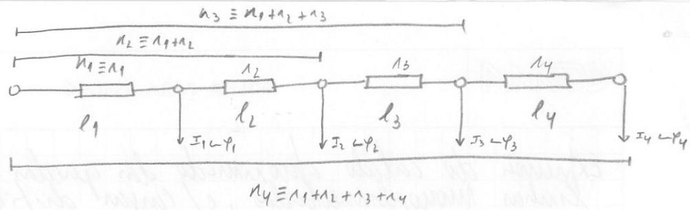
$$\Delta U_{\text{máx}} \approx 2n_1 I_1 \omega \varphi_1 + 2n_2 I_2 \omega \varphi_2 + 2n_3 I_3 \omega \varphi_3 + 2n_4 I_4 \omega \varphi_4 \\ \approx 2n_1 (I_1 \omega \varphi_1 + I_2 \omega \varphi_2 + I_3 \omega \varphi_3 + I_4 \omega \varphi_4) + 2n_2 (I_2 \omega \varphi_2 + I_3 \omega \varphi_3 + \dots)$$
