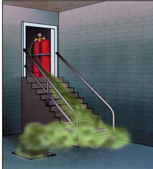
Fig. 2.3: Modo de propagação de gases liquefeitos (exemplo) 4
