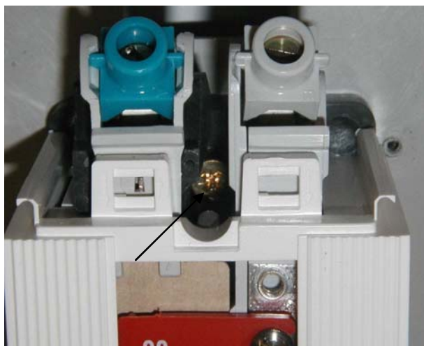
Fig. 29 – Fixação na parte superior de um DCP bipolar
