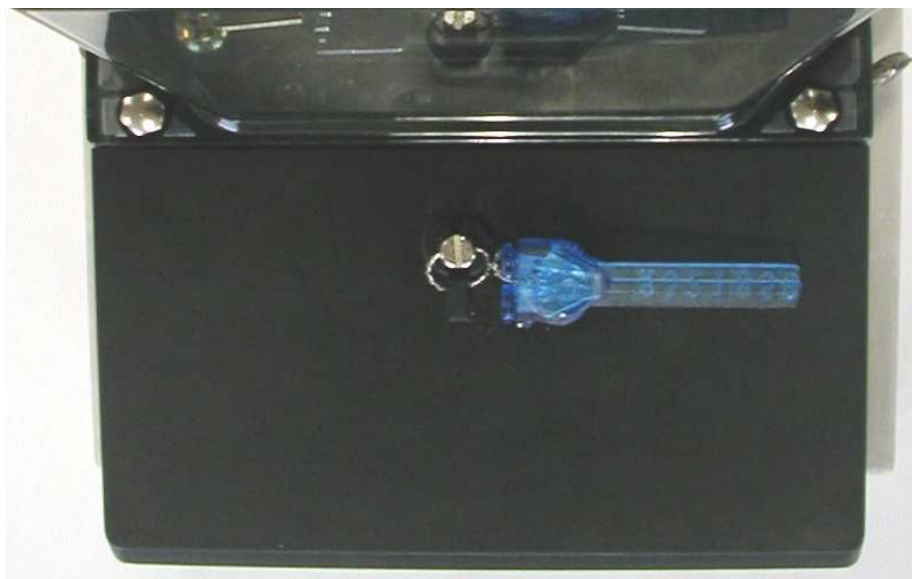
Fig. 25 – Selagem da tampa com um único parafuso
