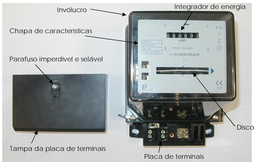
Fig. 5 – Partes constituintes de um contador
