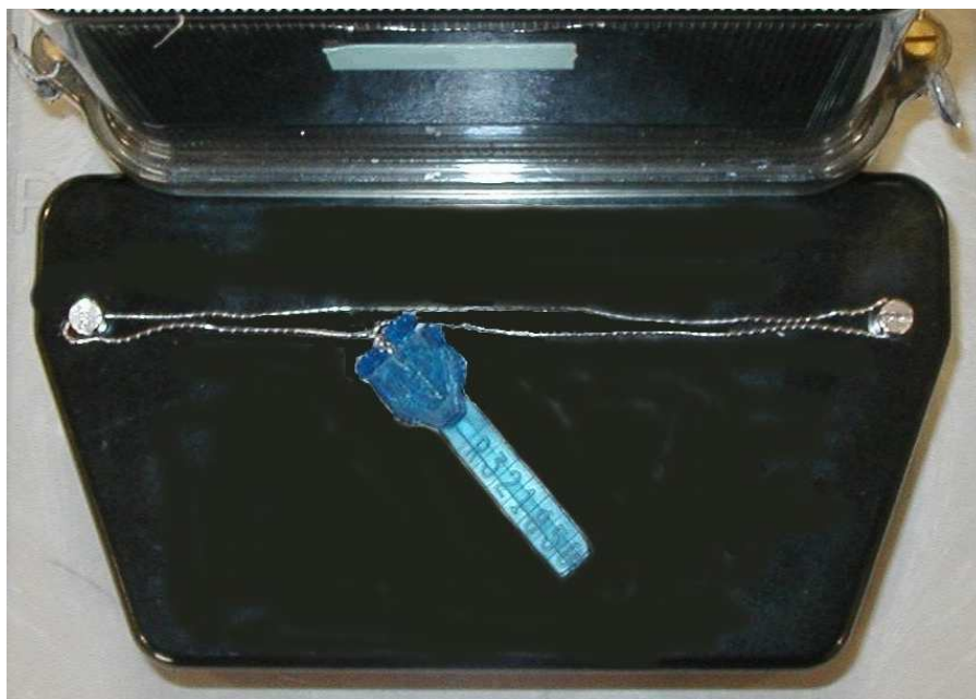
Fig. 26 – Selagem da tampa com dois parafusos
