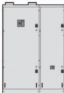
Armário A3B com disjuntor de entrada.
