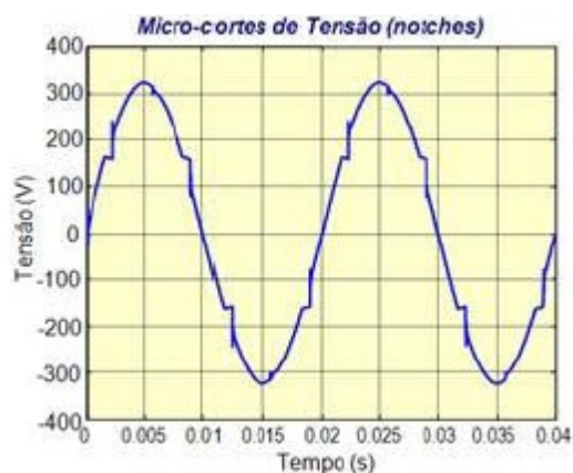
Figura 10 - Micro-cortes na tensão (notches).
