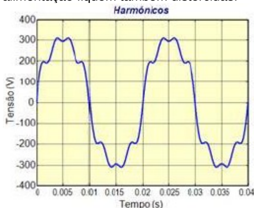
Figura 3 - Tensão com distorção harmónica.
