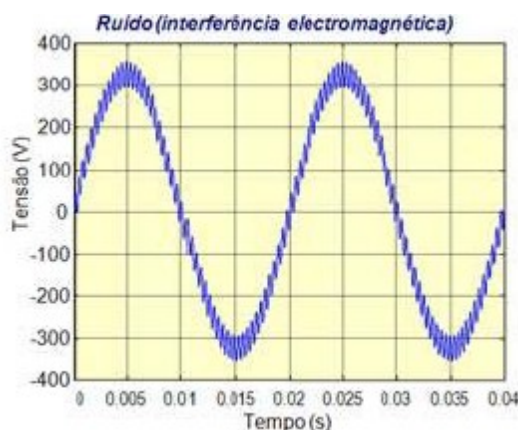
Figura 4 - Tensão com ruído de alta frequência.
