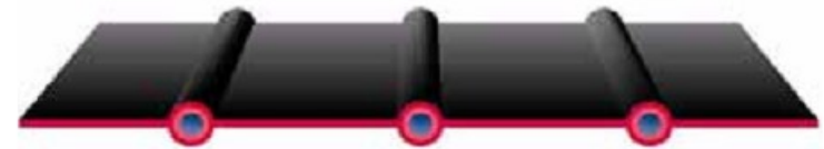
Absoror com sistema de tubos prensados entre duas chapas Fonte: KBB
