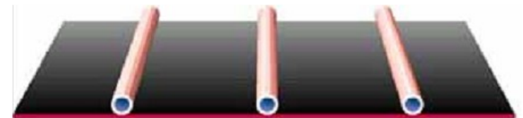
Absoror com um sistema de tubos soldados numa chapa de metal Fonte: Wagner
