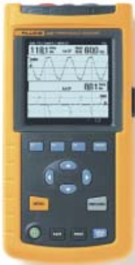
Figura 16 - Exemplo de instrumento de valor eficaz verdadeiro (cortesia Fluke do Brasil).
