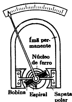
Instrumento de bobina móvel
