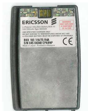
Figura 6.8 - Célula de polímeros de lítio utilizada em telemóveis
