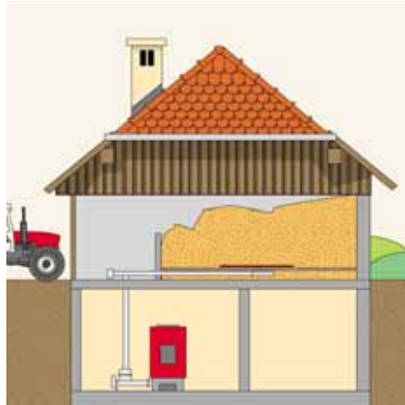
Figura 5.67 - Depósitos de estilhas de madeira convencionais sem acesso veicular
