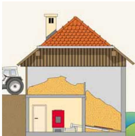
Figura 5.68 - Depósito de estilhas de madeira com secagem preliminar
