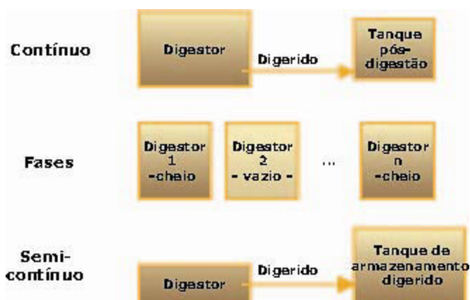
Figura 3.9 - Esquema de processos de digestão anaeróbia
