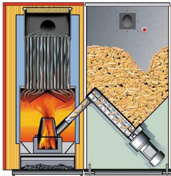
Figura 5.33 – Secção de sistema de alimentação superior
