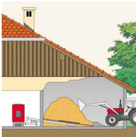
Figura 5.66 - Depósitos de estilhas de madeira com acesso veicular directo
