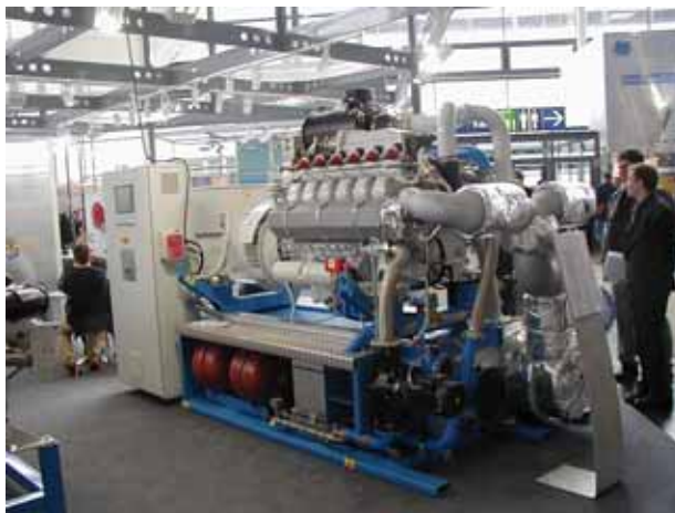
Figura 2.65 - Sistema de cogeração de injeção a gás com saída de 300 kW
