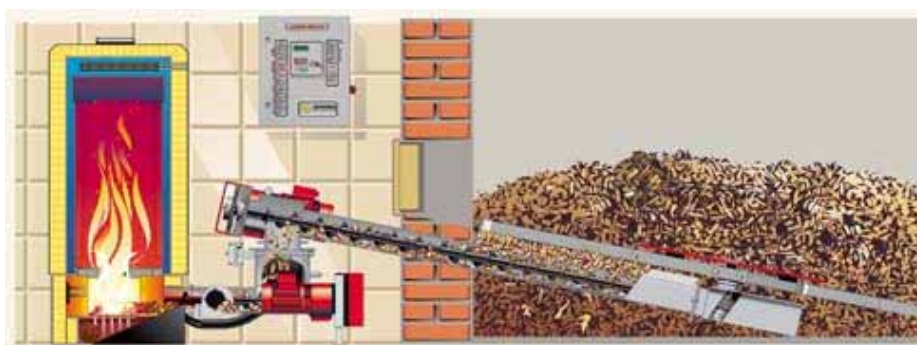
Figura 5.38 – Transporte de estilhas para a zona de combustão
