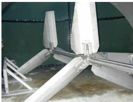
Figura 3.17 - Agitador de parafuso
