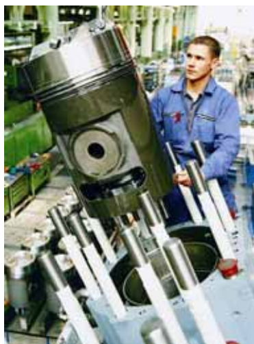
Figura 2.66 - Ajuste de um êmbolo num motor de grandes dimensões
