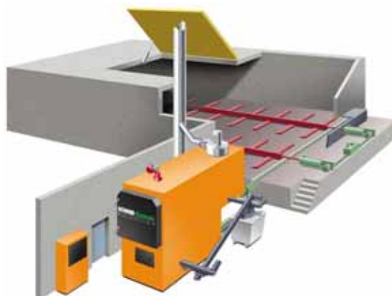
Figura 6.6 – Caldeira de grandes dimensões com depósito para combustível
