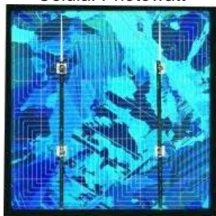
Figura 2.51 - Célula policristalina com AR e filamentos eléctricos
