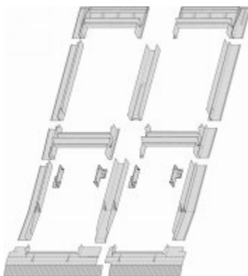
Figura 8.102 - Estrutura de montagem do sistema solar Roto
