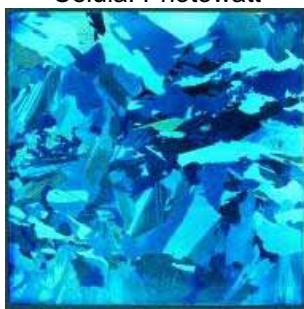
Figura 2.50 - Pastilha policristalina com uma camada de anti-reflexão
