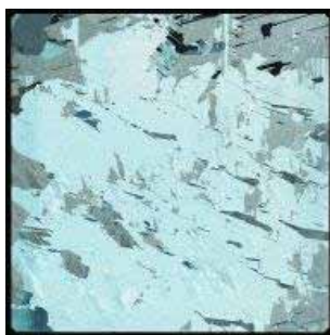
Figura 2.49 - Pastilha policristalina sem a camada de anti-reflexão
