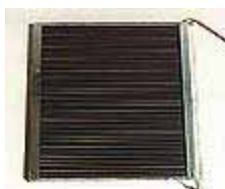
Figura 2.89 - Protótipo de um módulo fotoelectroquímico (50cm x50 cm)
