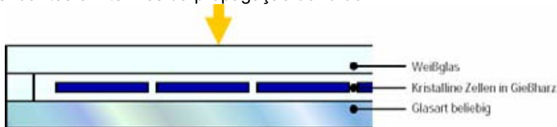
Figura 3.10 - Módulo vidro-vidro (resina fundida)
