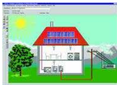
Figura 7.9 - Menu principal para a simulação de sistemas fotovoltaicos com ligação à rede no PV*SOL
