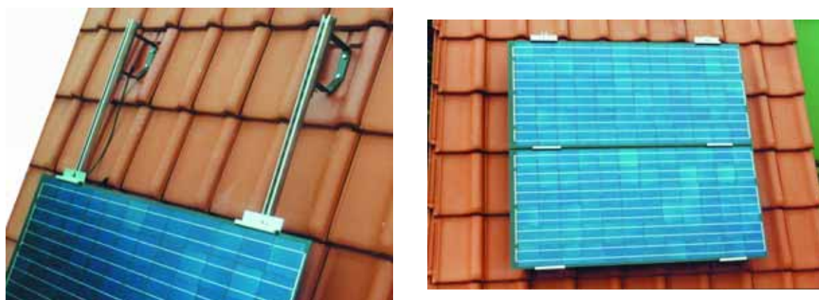
Figura 8.41 - Sistema Solar Universal Telha de fixação (em função do telhado) e montagem dos módulos da base para o topo Fotografias: Laumans
