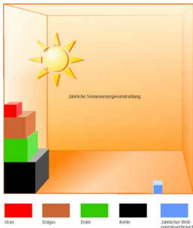
Figura 2.19 – Conteúdo energético da radiação solar na superfície terrestre, em contraste com o consumo mundial de energia e com as reservas dos recursos de energia fóssil e nuclear dados: BMWi 2000
