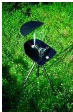
Figura 4.1 - Análise de sombreamento, utilizando uma câmara com acessórios especiais de geometria solar Arquitectos Sol-id-ar
