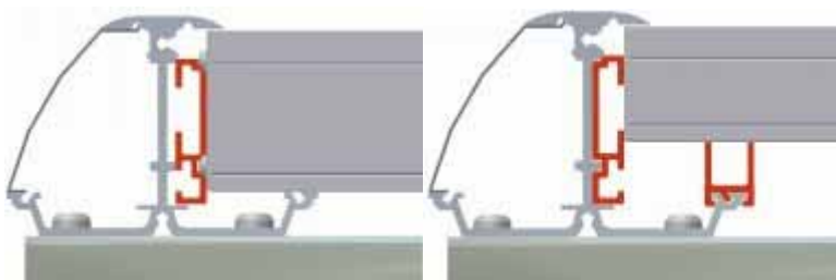
Figura 8.35 - Secção com e sem calços para ajuste da altura da armação dos módulos
