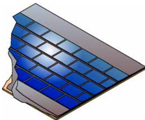
Figura 8.72 - Assentamento das telhas planas SHR
