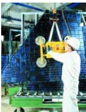
Figura 3.20 - Produção de um modulo específico em forma de trapézio
