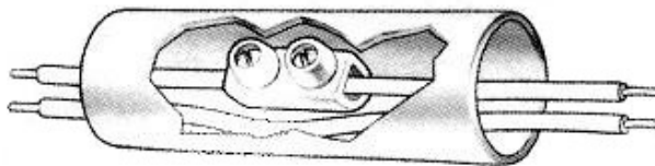
Fig. 14 - Não é permitida a emenda interior indicada.
