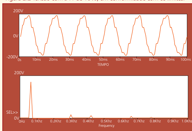
Figura 2.2 Tensão com DTT de 10%, em conformidade com os limites.
