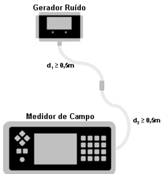
Figura 108 – Calibração do sistema de medida
