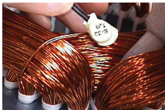
Figura 7.6 - Instalação do protetor térmico bimetálico
