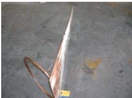
Figura 2 – Exemplo de terra com chapa de cobre: dimensões: 500 x 500 x 1,1 mm
