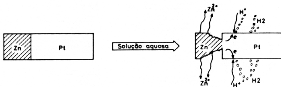
Figura 10 - Esquema representativo do mecanismo de corrosão galvânica [20].
