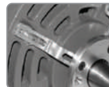
Instalação do epóxi condutivo AEGIS® EP2400
